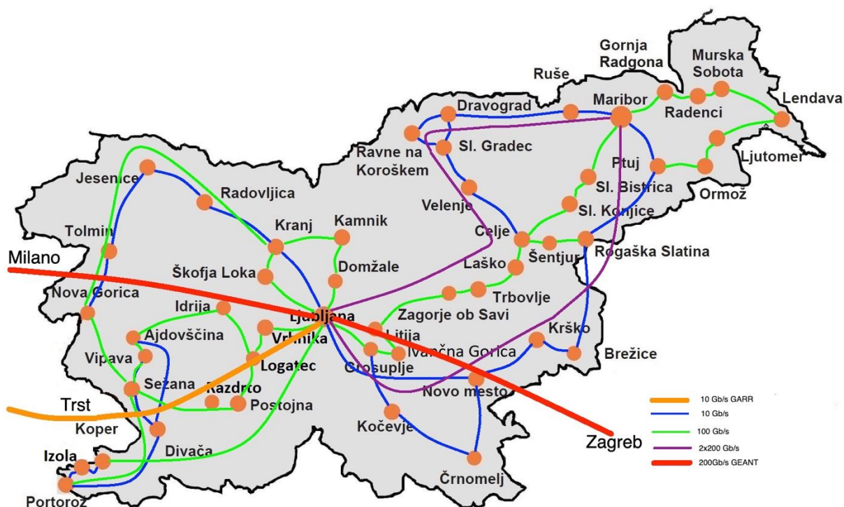
Slika 2: IP-povezave za zagotavljanje IP-povezljivosti, zgrajene na osnovi zakupljenih optičnih vlaken, konec leta 2023
